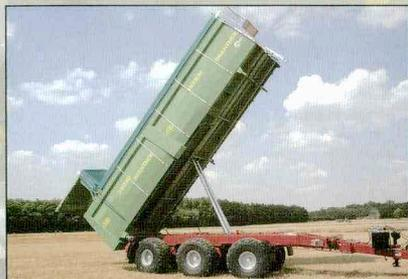
Tridemkipper - Zwangselenkung und Planenaufbau
