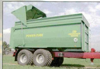
Aufsatzwände in den Höhen 400, 500 u. 600 mm
