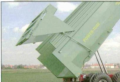
automatische hydraulische Rückwandöffnung
