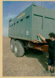
Stabilator: 150 cm hohe, innen glatte Seitenwände mit Pendelung oben. Unten riegeln sieben Scharniere zentral. Zum Teil muss man beim Arretieren der Wände trotz Schließhaken von Hand nachhelfen.
