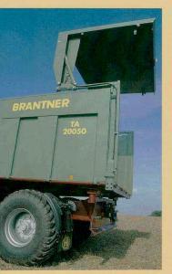
Die Abstützung der Heckklappe am Galgen und den Bordwänden fällt nicht zu massiv aus, funktioniert aber.
