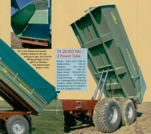
Zwei 180 cm Hubzylinder (vierstufig) sorgen für 51 Grad Kippwinkel. Für Silagebetrieb ist das auch Untergrenze.
