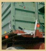
Die Bordwände reinigen beim Schließen den runden Brückenrand (1), Sieben Scharniere sind bei 5 m Standard, die hydraulische Öffnung (2) kostet Aufpreis.
