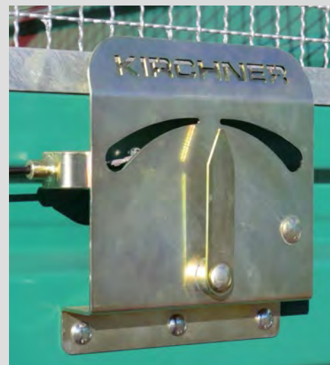
Dzięki mechanicznemu wskaźnikowi również z kabiny ciągnika widać ustawienie osi kierującej
