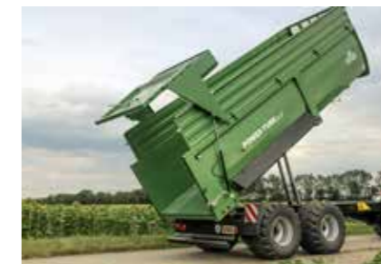
TA 24080/2 PT+ długość skrzyni 8000 mm, standard z zawieszeniem pneumatycznym i automatycznym opuszczaniem wywrotu
