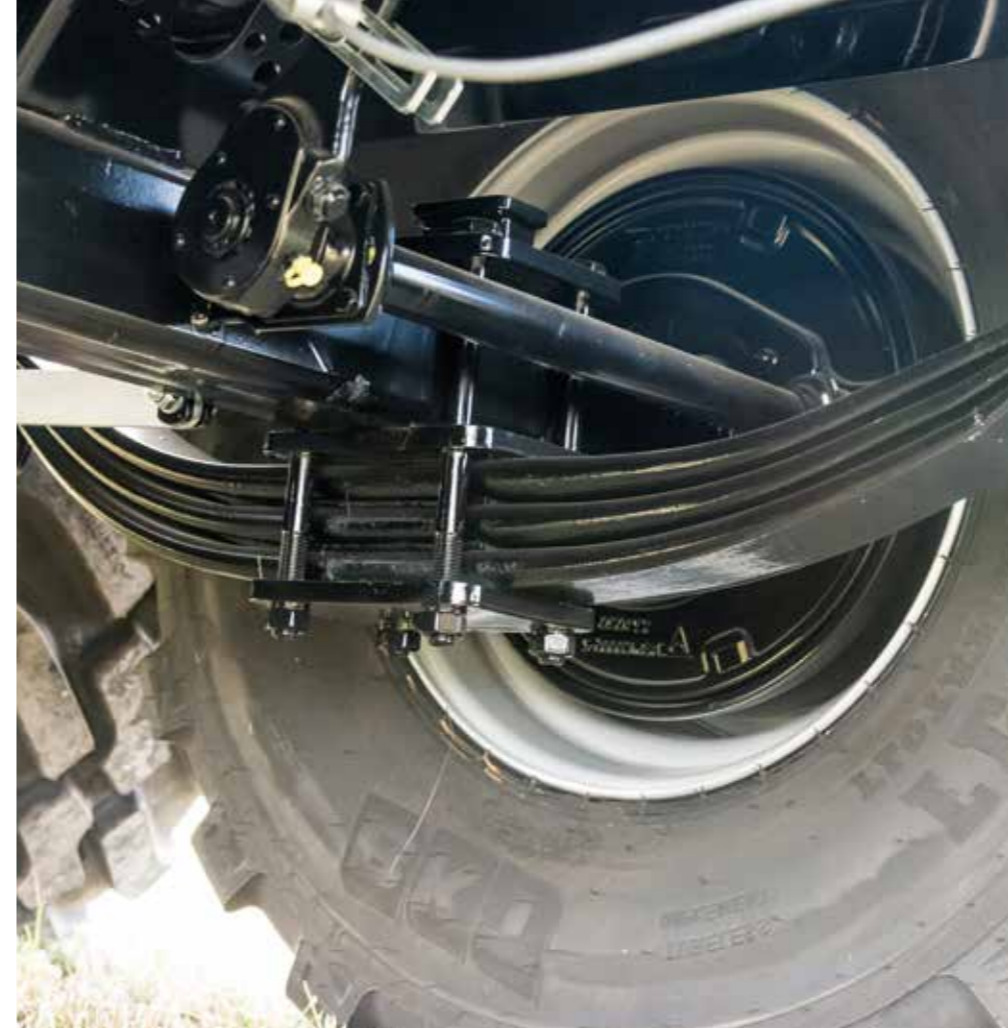
32t układ resorujący z wzmocnionym układem wahadłowym
