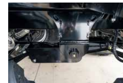
Przesunięte zawieszenie tandemowe dostosowane do osi skrętnej, lepsza stabilność i ograniczenie tendencji do kołysania się
