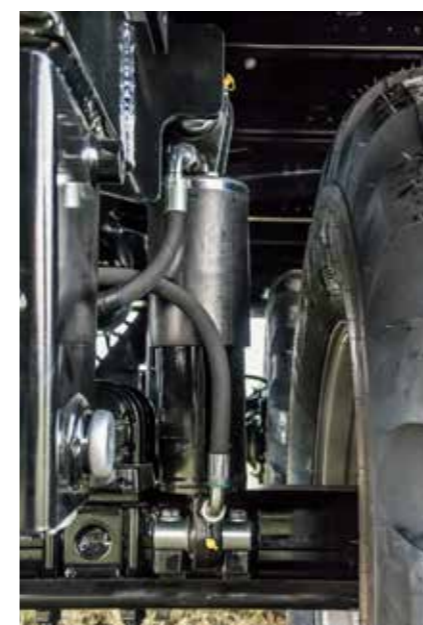
Zawieszenie hydrauliczne zapewnia maksymalną stabilność na zakrętach i na zbozcach
