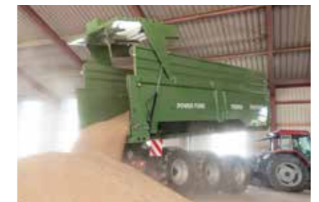
TR 34080/2 PT+ 34t masy całkowitej, na życzenie z hydrauliczno-mechanicznym lub elektrycznym wymuszonym kierowaniem
