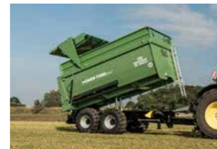
TA 20053/2 PT z korytem stożkowym, wykonany w całości z blachy stalowej o grubości 4 mm
