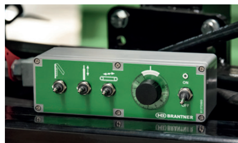
Elektronické řízení posuvu s doplňkovou funkcí pro ochranu opěrné zdi a rozmetadla
