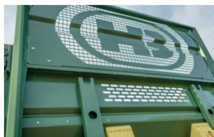
Velká ochranná mříž chrání proti odletujícím kamínkům a nabízí optimální výhled na ložnou plochu
