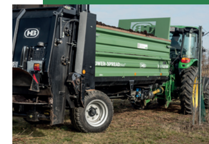
Inovace od Brantner volitelně hydraulicky řízená náprava
