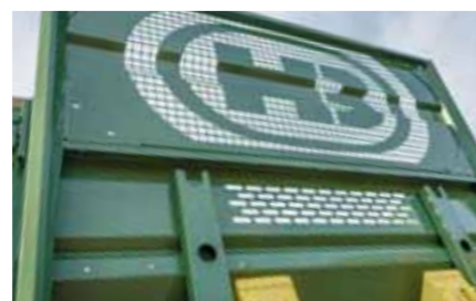
Duża kratka ochronna chroni przed odpryskami kamieni i zapewnia optymalną widoczność obszaru
