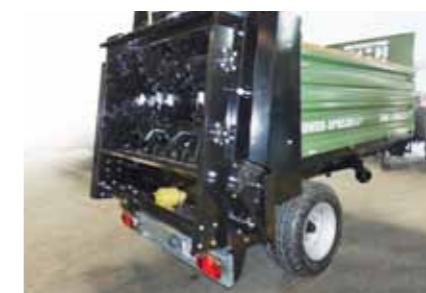
Rozrzutnik F2H rozrzutnik do materiałów drobnych z dwoma poziomymi wałkami frezującymi
