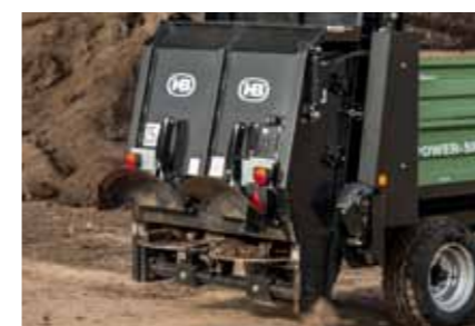
Rozrzutnik uniwersalny CL2-2 rozrzutnik kompostu z dwoma poziomymi wałkami frezującymi i tarczami rozrzucającymi
