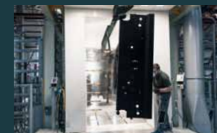
Automatyczne malowanie proszkowe
