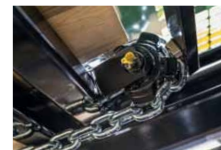
Koło łańcuchowe z odpornego na zużycie żeliwa sferoidalnego, opcjonalnie smarowane listwą smarującą
