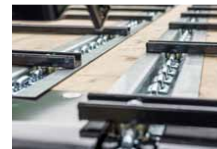
2 łańcuchy (łańcuch stalowy okrągły 10 x 31 mm), obciążenie zrywające 12,5 t, ocynkowane, kalibrowane parami
