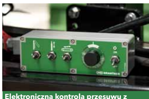
Elektroniczna kontrola przesuwu z dodatkową funkcją dla ściany grodziowej i pokrywy ochronnej adaptera
