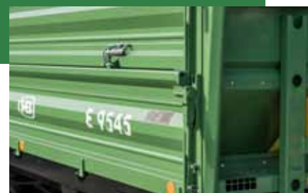
Elementy mocujące do szybkiego montażu i demontażu
