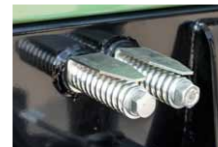
Napinacz łańcucha automatyczny napinacz łańcucha ze skalą na przedniej ścianie
