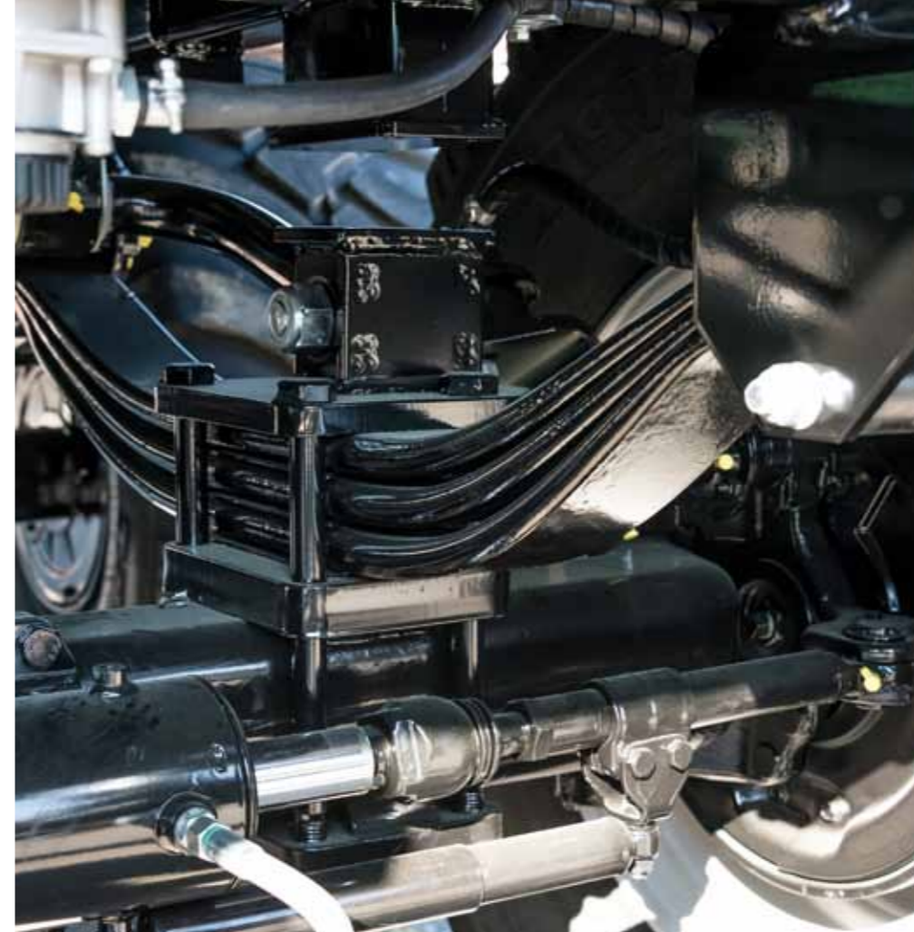
32t układ resorujący wzmocniony układ wahadłowy
