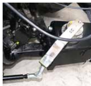
Elektryczny wymuszony układ kierowniczy
