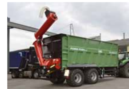
Przenośnik ślimakowy składany hydraulicznie, z przenośnikiem ślimakowym poprzecznym
