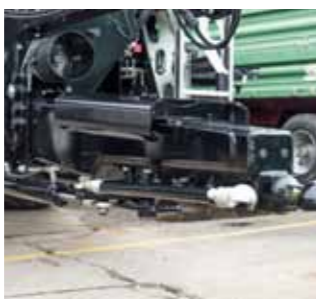
Hydrauliczno-mechaniczny wymuszony układ kierowniczy
