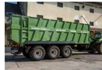
TR 34090 PP+ podwozie tridem, 34 t DMC, 43 lub 49 m 3 ładowności
