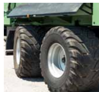
Meddrejende aksel med låsefunktion
