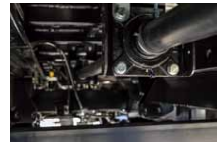
PTO driv-line til spredner og tømmesnegl
