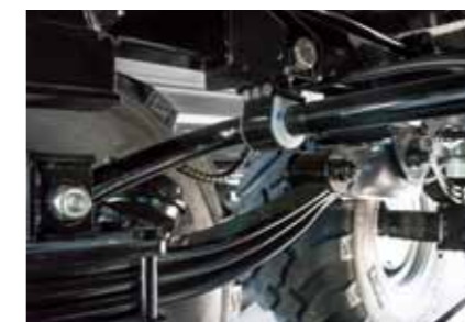
Fjederstabilisator Anbefales kraftigt til styrende aksler (kun muligt med parabolisk affjedring)
