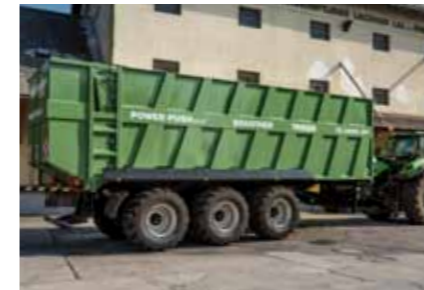
TR 34090 PP+ Tre-akslet chassis, 34 tons totalvægt, 43 eller 49 m 3 lastekapacitet
