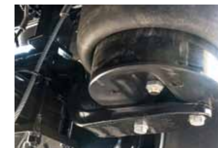
Luftaffjedring Med dobbelt funktion for optimal stabilitet.
