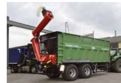
Tømmesnegl Som hydraulisk sammenklappelig med tværtransportsnegl
