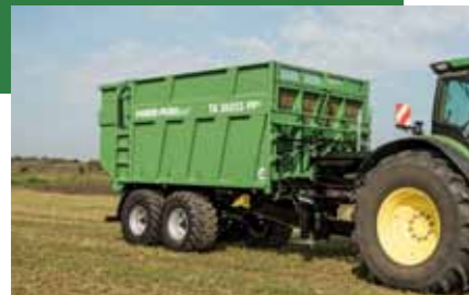
TA 16055 PP+ Med en lastkapacitet på 20 til 26 m 3
