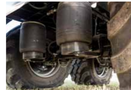
Forskellige affjedningsmuligheder, f.eks. luftaffjedring eller hydraulisk affjedring
