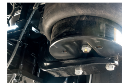
Vzduchové odpružení s dvoulistým článkem pro optimální stabilitu a mobilitu v terénu
