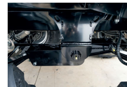
Odstupňované zavěšení tandem- ové jednotky přizpůsobené řízení nápravě, lepší stabilita a snížení sklo- nu k přetáčení
