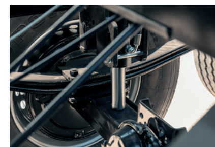
Hidrauličko oslanjanje zadnje osovine serijski za optimalan komfor vožnje
