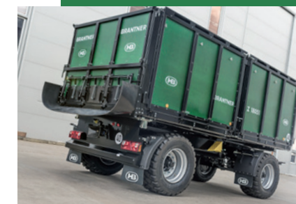
tobogan za lakši istovar osetljivog materijala (npr. krompir)
