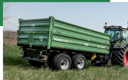
TA 10041 nudi raznovrsnu opremu, npr. sa stepenicama za stoku, hidraulički zadnji zid ili vrata za šut
