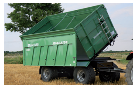
glatke unutrašnje stranice sa koničnom platformom i potpuno glatkom površinom unutrašnjih stranica olakšavaju isklizavanje materijala
