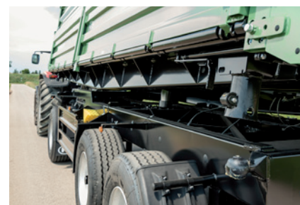
Trapezni ram kamionskog tipa sa ležajevim kipanja na spoljoj tački
