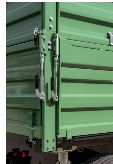
HB-kamionski zatvarači komforno upravljanje na optimalnoj visini
