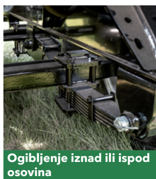
Parabolično ogibljenje iznad osovina
