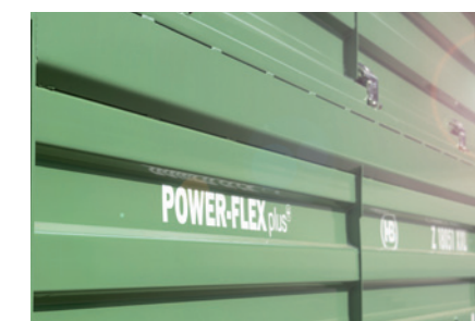
Ojačanje stranice od 6mm čeličnog lima i kutijastim profilom, fiksno zavareno
