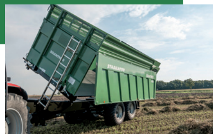
Klateća stranica na ležaju levo i desno, jednostavno otvaranje.
