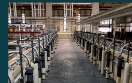
KTL & priprema 12 potapanja za hemijsko čišćenje i KTL-tretman površine
