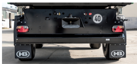
Multi-Point rasveta sa gumenom zaštitom od prskanja
