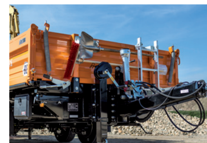
TA13045 niskopodna prikolica serijski sa po visini podesivom rudom, i opcionim držačem za metlu i lopatu
