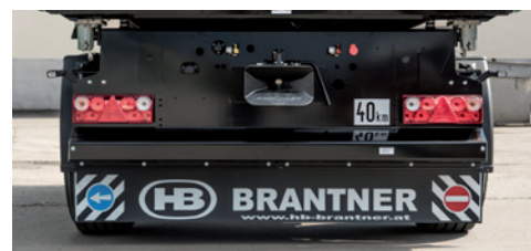
Europoint II rasveta sa gumenom zaštitom od prskanja celom širinom
