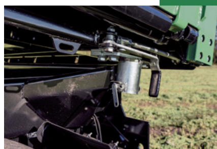
Ležajevi klanja na spoljnoj strani za još više stabilnosti
