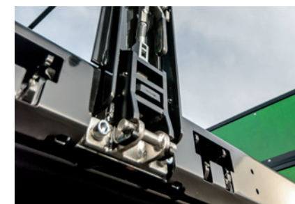
skidanje srednjeg stuba bez alata, opcija za lakše tovarenje kutija i paleta
