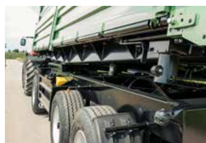
Trapezowa rama wywrotu - oparta na konstrukcji aut ciężarowych z łożami wywrotu umieszczonymi daleko na zewnątrz
