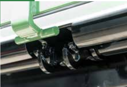
Zawiasy burtowe od 5 m długości platformy z podwójnym ryglowaniem
