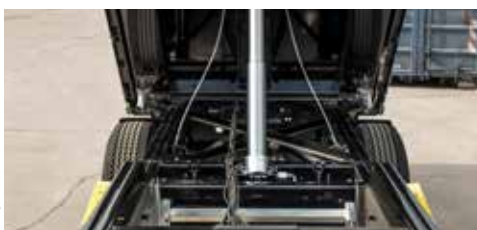
Wersja z jednym siłownikiem wywrotu
