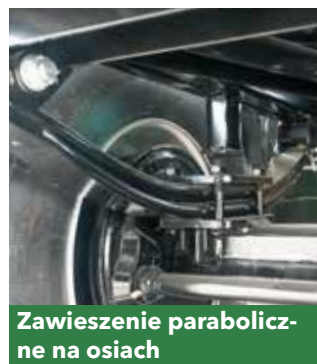
Zawieszenie paraboliczne pod osiami
