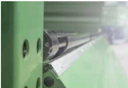
Samoczyszcząca krawędź platformy ładunkowej - ze wszystkich czterech stron
