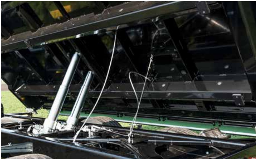
Trapezowa rama wywrotu - oparta na konstrukcji aut ciężarowych wraz ze wzmocnieniami usztywniającymi
