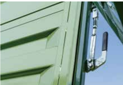
Metalowe uszczelnienie profilowane na słupku narożnym dla tylnej burty i nadstawki
