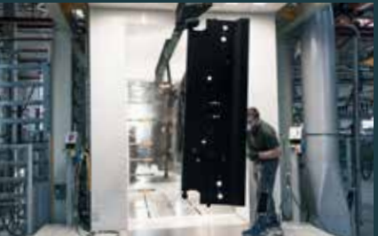
Automatyczne malowanie proszkowe
