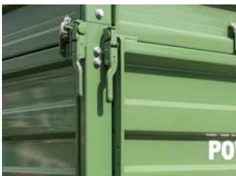
Zamki Hestál, bez wzmocnienia ściany bocznej
