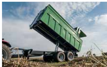
Hydrauliczna klapa tylna opcjonalnie z hydr. tylny panel
