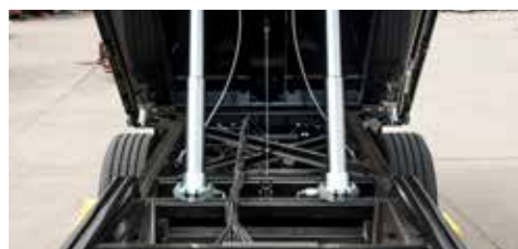
Wersja z dwoma siłownikami wywrotu
