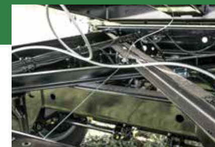
Wzmocnienie krzyżowe - zwiększona sztywność skrętna
