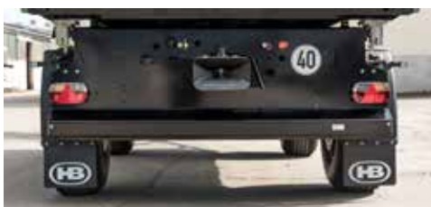
Oświetlenie wielopunktowe Multi-Point z chłapaczami na błotnikach
