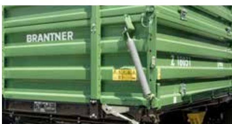
Prosta sprężyna do podnoszenia burty bocznej
