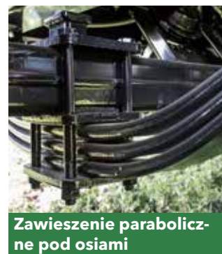
Zawieszenie paraboliczne na osiach
