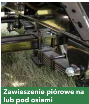
Zawieszenie paraboliczne na osiach
