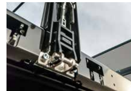
Słupek środkowy, który można zdemontować bez użycia narzędzi, może być pomocny podczas ładowania skrzyń lub palet
