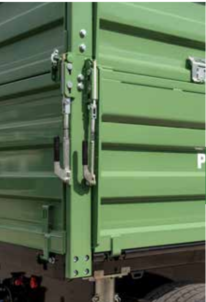
HB-ciężarowe zamknięcia zapewniają wygodną obsługę na optymalnej wysokości roboczej
