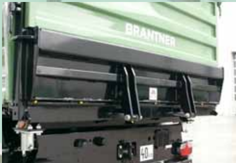
hydraulische opening v/d achterklep 120° van persprofiel
