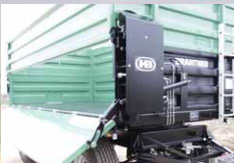
hydraulische bordwandopening zijdelings 180° openen en sluiten
