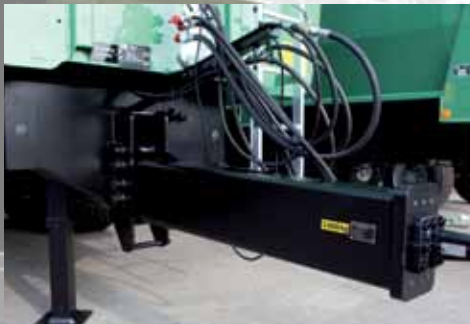
Onder- aanspanning met trekdissel van dubbel-C persprofiel
