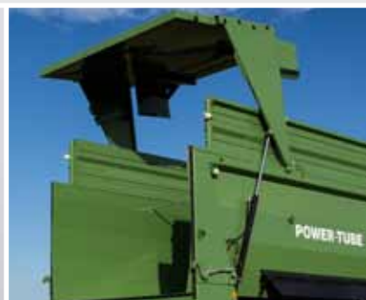
hydraulische, dubbelwerkende achterklepopening
