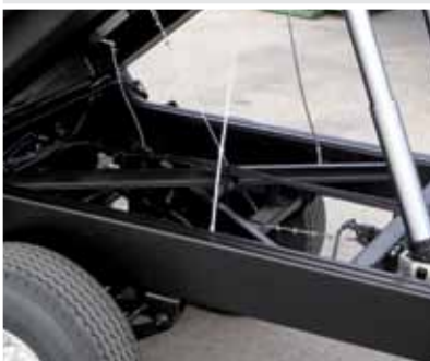
Kruisschoring v/h onderstel-frame
