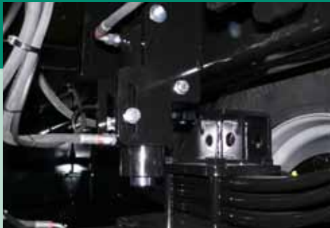
hydraulische achterondersteuning gecombineerd met hydraulische achterklepopening
