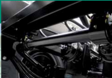
Veerstabilisator voor optimale rijeigenschappen
