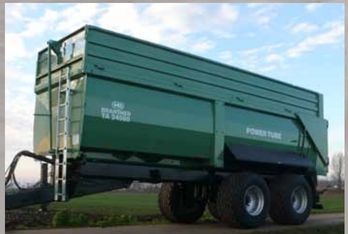
TA 24080/2 Power Tube baklengte 8.000 mm (gestuurde as en spoor 2.250 mm standaard)
