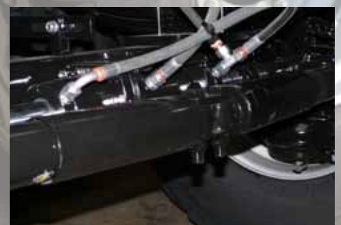
As met naloopbesturing vergrendelen bij achteruit rijden en wegtransport vereist
