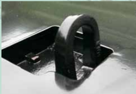
Bevestigingshaken EN 12640 in de laadvloer verzonken
