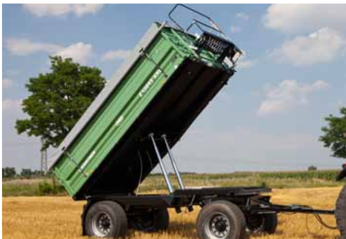
Z 13045/2 XXL mit 2 Kippzylinders für optimale Kippstabilität bovenbouw-afscherming
