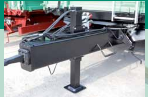
hydraulische steunpoot dubbelwerkend, buis-in-buis geleiding
