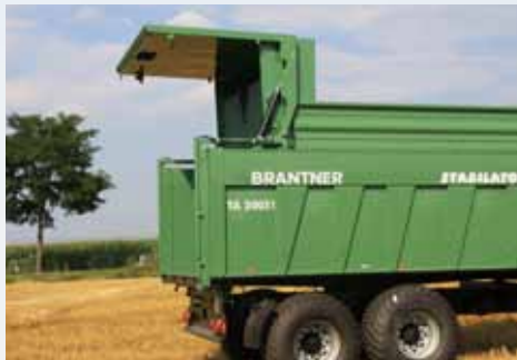
hydraulische achterklepopening dubbelwerkend
