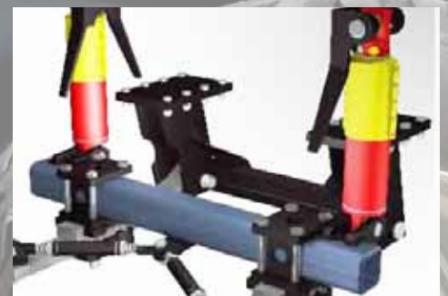
Hydraulisch onderstel onderstel hydraulisch geveerd
