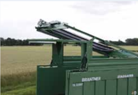
Cabrio bovenbouwbescherming in combinatie met hydraulische achterwand
