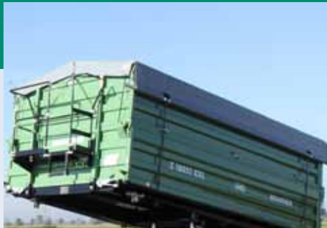
Bovenbouw afscherming met opzetdriehoeken en bedieningsplatform
