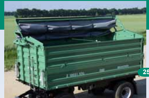
Cabrio bovenbouw afscherming hydraulisch
