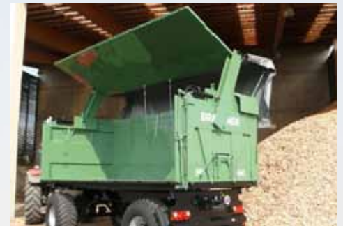
hydraulische stabilisatorzijwand naar boven geopend
