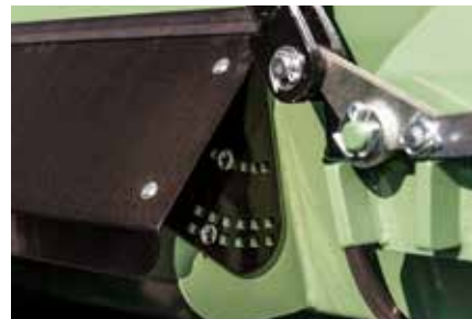
Spritzschutz verstellbar für optimale Anpassung
