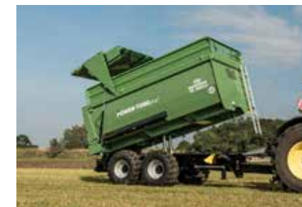
TA 20053/2 PT+ mit konischer Mulde, durchgehend aus 4 mm starkem Stahlblech
