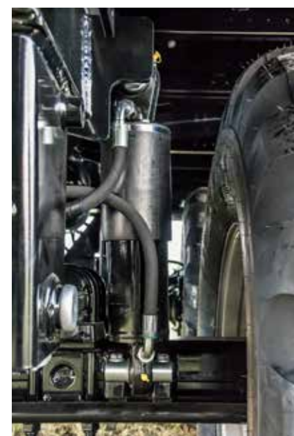
Hydraulikfederung höchstmögliche Kurven- und Hangstabilität
