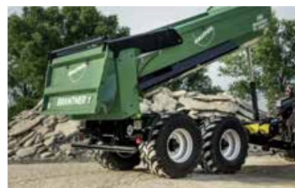
hydraulische Pendelklappe hydraulische Rückwandöffnung doppeltwirkend mit Doppelfunktion
