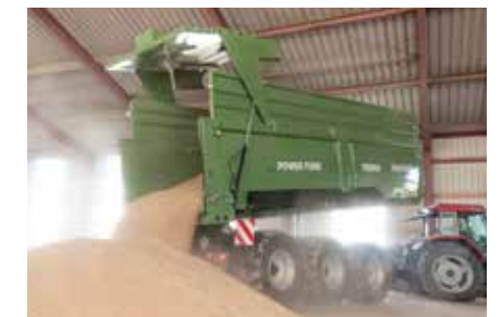
TR 34080/2 PT+ 34 t Gesamtgewicht, auf Wunsch mit hydraulisch-mechanischer oder elektrischer Zwangslenkung
