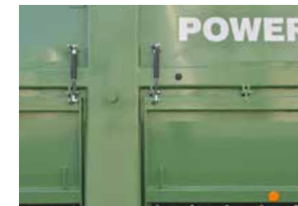
geteilte Wände für mehr Stabilität der Mulde
