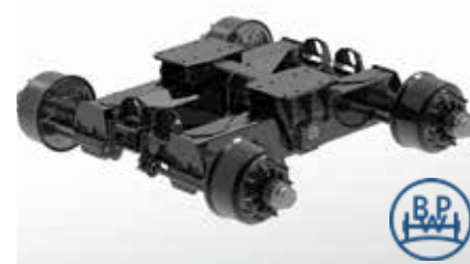
BPW- Pendelaggregat mit verstärkten Achsen Vierkant 150 x 20 mm, Bremse 410 x 180 mm
