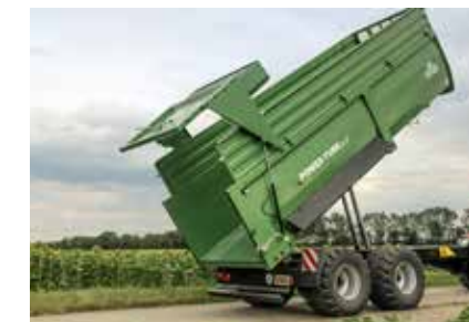
TA 24080/2 PT+ Muldenlänge 8000 mm, serienmäßig mit Luftfederung und automatischer Kippabsenkung
