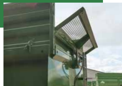
Stirnwand hydraulisch abklappbar
