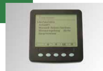
HP Premium Steuerung Liftachse, Anfahrhilfe, etc. (Hydraulikfederung)
