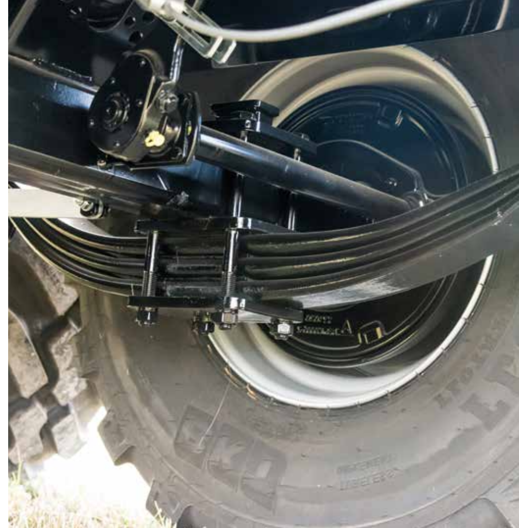
32 to Federaggregat mit verstärkter Ausgleichswippe
