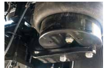
Luftfederung mit Zweiblattlenker für optimale Standsicherheit und Geländegängigkeit
