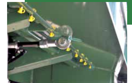
Innovation von Brantner hydraulisch angesteuerte Pendelfunktion zum Öffnen und Schließen
