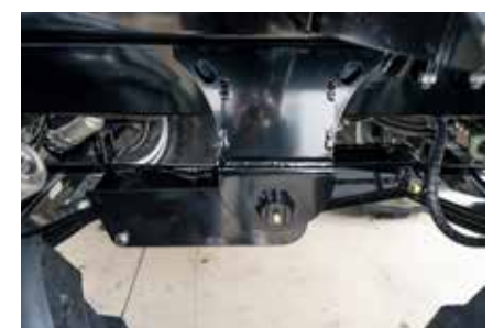
versetztes Tandemaggregat Federung bei Lenkachse angepasst, bessere Standsicherheit und Reduzierung der Wankneigung
