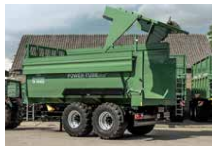
abklappbare Aufsatzwände hydraulische Rückwand kann bei abgeklappten Aufsatzwänden geöffnet werden
