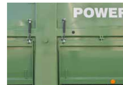
Paredes divididas para mayor estabilidad de la caja
