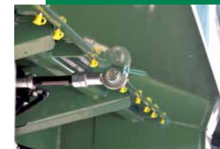
Innovación de Brantner función de péndulo controlada hidráulicamente para la apertura y
