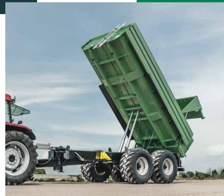
TA 22065/2 XPT+ Ejes reforzados con unidad de suspensión de 32 t, ojo de remolque con brida K 80 para una carga máxima de timón de 4 t
