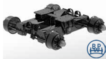
Unidad pendular BPW Con ejes reforzados cuadrados de 150 x 20 mm y freno de 410 x 180 mm
