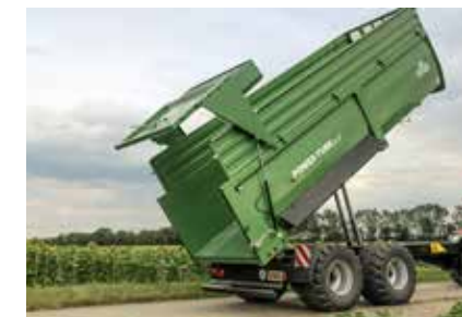
TA 24080/2 PT+ Longitud de la carrocería de 8000 mm, con suspensión neumática y descenso automático de volcado de serie
