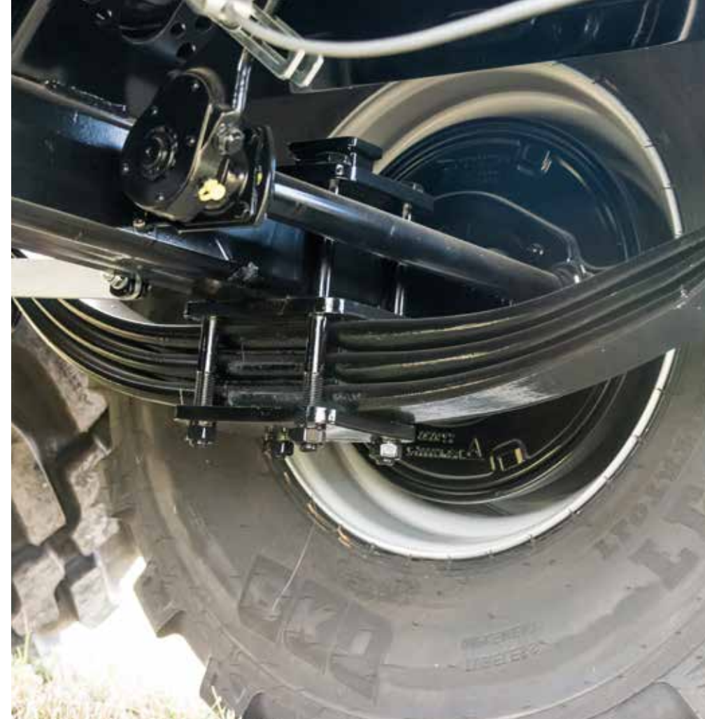
Unidad de suspensión de 32 t con balancín compensador reforzado
