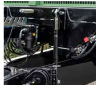
Wysokość zaczepu regulowana za pomocą wrzecion
