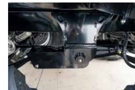
Przesunięte zawieszenie tandemowe dostosowane do soi skrętnej, lepsza stabilność i ograniczenie tendencji do kołysania się
