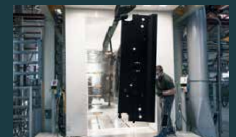
Automatyczne malowanie proszkowe
