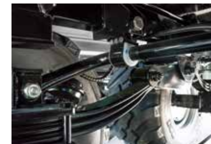
Stabilizator resorów wysoce zalecany do osi skrętnych (możliwy tylko z zawieszeniem parabolicznym)
