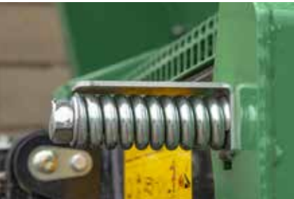
Tendeur de chaîne à ressort avec indicateur sur la paroi frontale.
