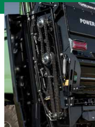
Entraînement par chaîne de l'hérisson inférieur avec chaîne duplex 1 pouce et de l'hérisson supérieur avec chaîne 5/4 pouce.
