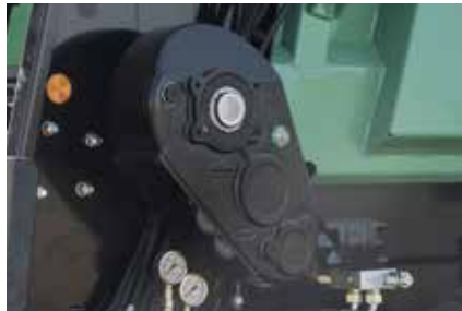
Entraînement du tapis racleur hydraulique via un réducteur à bain d'huile et protection contre les surcharges hydraulique.
