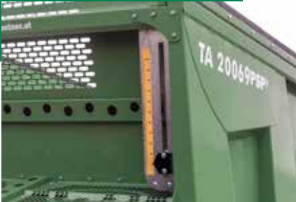
Indicateur de la retenue / guillotine monté sur la paroi frontale, avec guidage de câble dissimulé, protégeant contre les dépôts de saleté et les dysfonctionnements.
