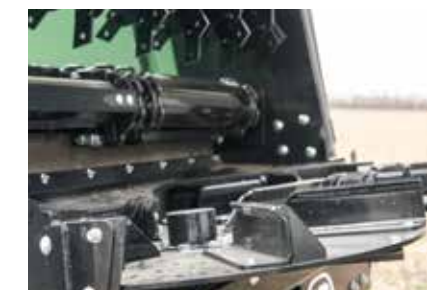
Disques d'épandage en Hardox de 10 mm avec 6 pales réglables
