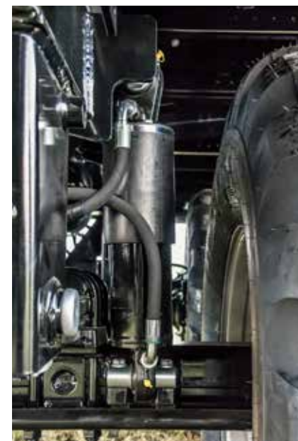
Suspension hydraulique offrant une stabilité maximale dans les virages et en pente
