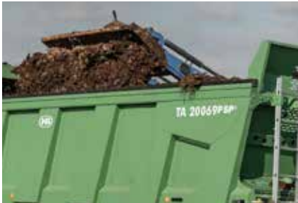
Bord de protection Lors du chargement, le bord de chargement est protégé contre les dommages par une barre d'usure en plastique.
