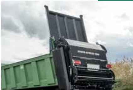
Paroi de retenue / guillotine inclinée Meilleure exploitation du volume de chargement et épandage parfait dès le départ.
