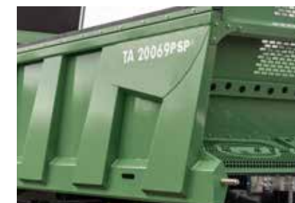
Parois latérales STABILATOR fixées au châssis dans deux directions
