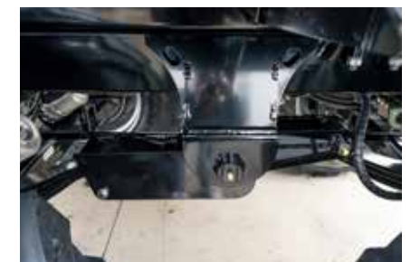
Essieu tandem décalé suspension optimisée pour essieu directeur, amélioration de la stabilité et diminution de la tendance au roulis
