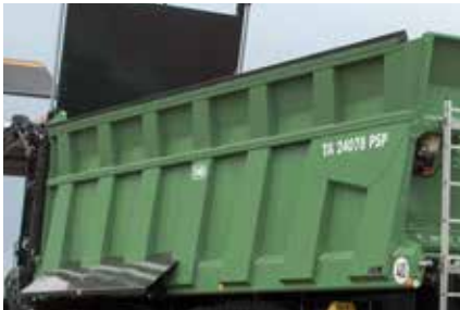
Rehausses Nos rehausses sont disponibles dans des hauteurs de 400 à 600 mm.
