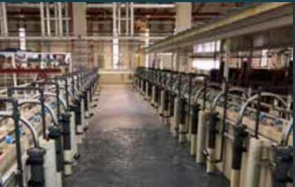
KTL & Prétraitement 12 cycles de trempage pour le nettoyage chimique et suivis d'un revêtement KTL.
