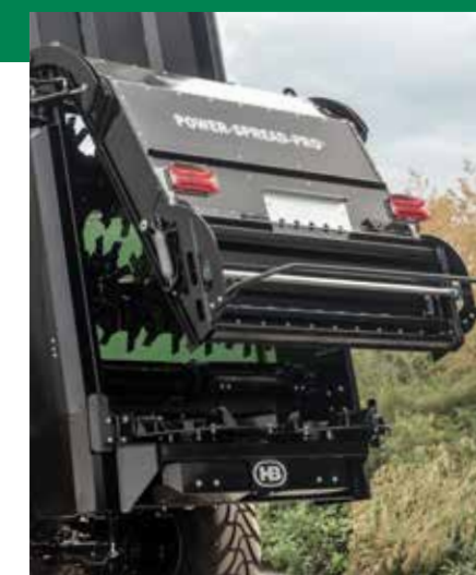
Trappe de protection contre les corps étrangers, réglable horizontalement et verticalement.
