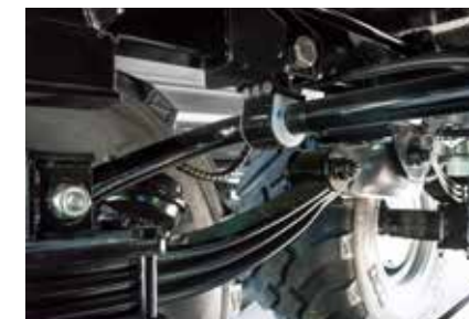
Stabilisateur de ressort fortement recommandé avec essieu directeur (uniquement compatible avec suspension à lames paraboliques)
