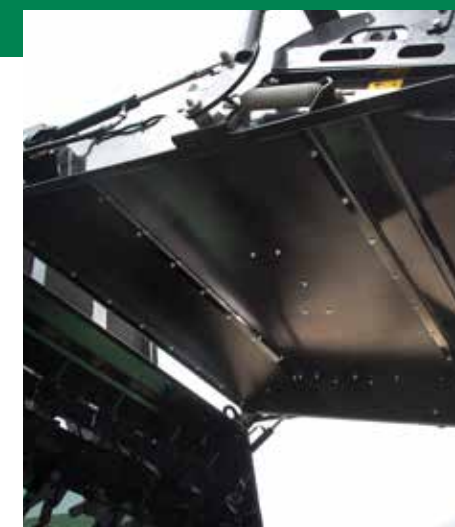
Capot hydraulique avec plaques d'usure en plastique.
