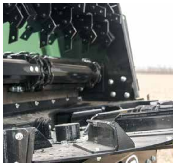
Deux disques d'épandage Ø 1 000 mm, équipés de 6 pales réglables
