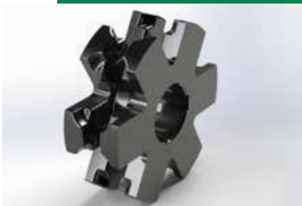
Pignon à 6 dents de Brantner pour une réduction de l'usure (angle de déviation de la chaîne d'environ 30°) sur la chaîne du tapis racleur.
