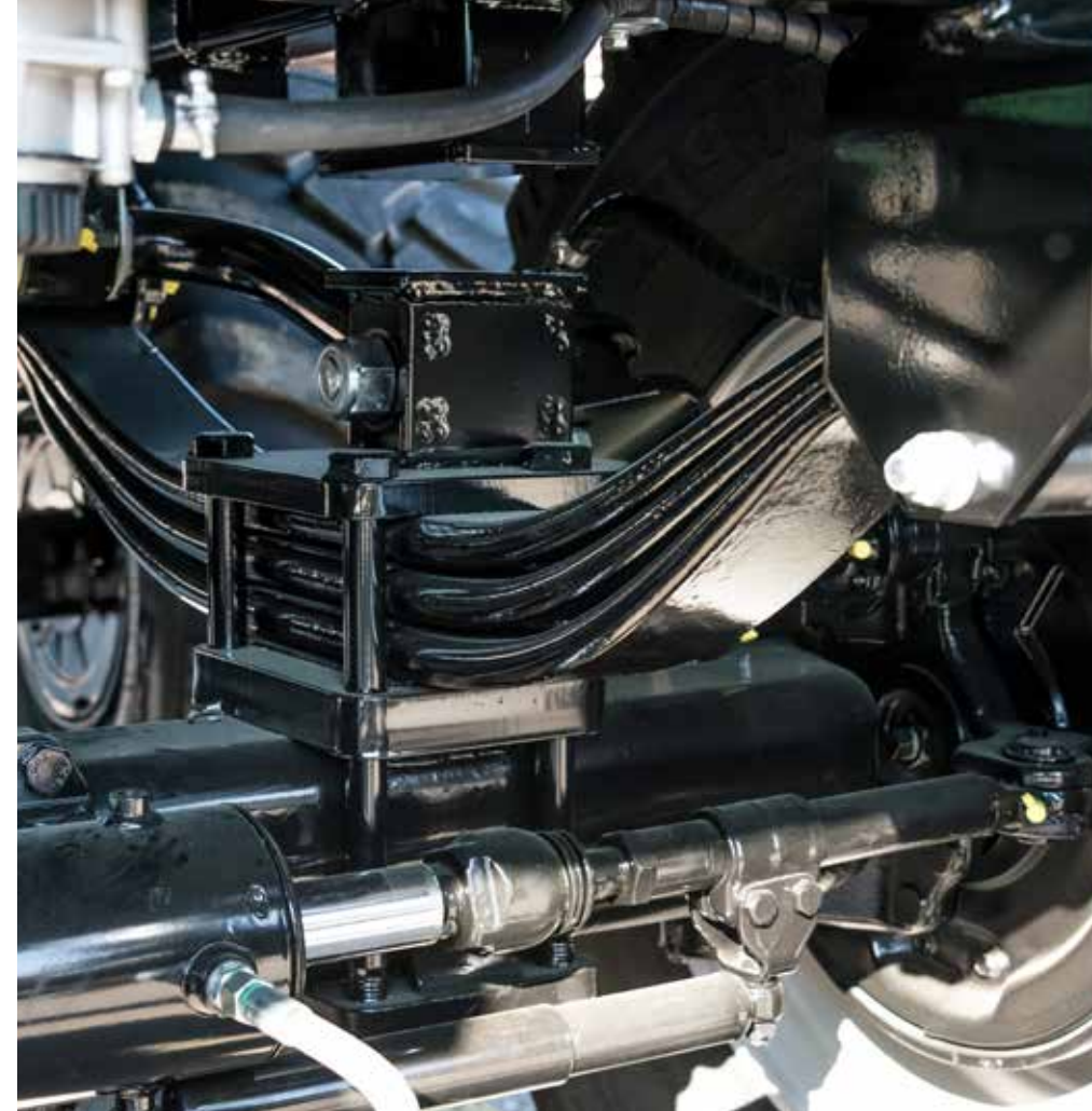
Unité de suspension 32 t avec balancier renforcé
