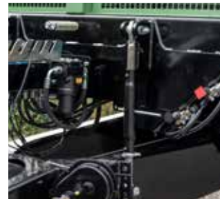
Hauteur de suspension du timon réglable par broches
