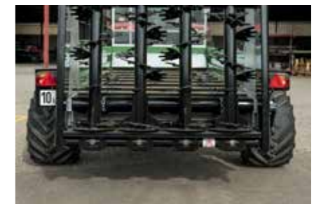
Spurweiten mit 2150/2200 mm bei allen Bergstreuer-Typen
