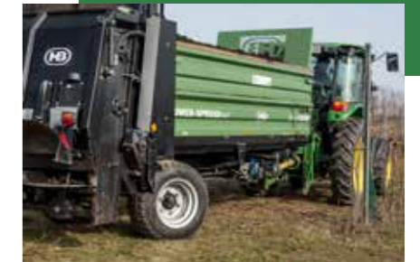
Innovation von Brantner optionale hydraulische Lenkachse
