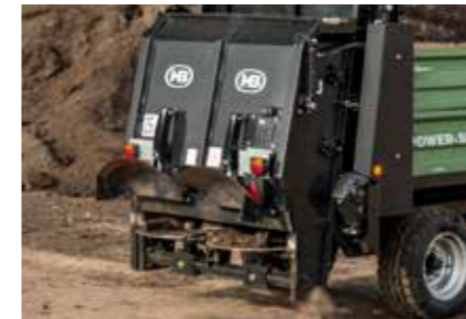
Universalstreuerwerk das CL2-2 Kompoststreuerwerk mit zwei liegenden Fräswalzen und Streutellern
