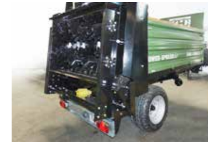
Streuwerk F2H Feinstreuerwerk mit zwei horizontalen Fräswalzen
