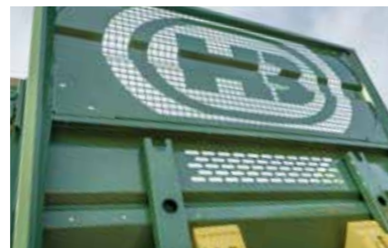
Großes Schutzgitter schützt vor Steinschlag und bietet optimale Einsicht in den Laderaum
