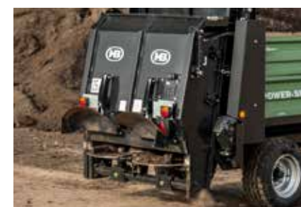
Univerzalni rasipač komposta CL2-2 sa dva horizontalna valjka za glodanje i diskovima za posipanje
