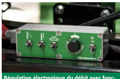
Régulation électronique du débit avec fonction supplémentaire pour la paroi de retenue et la protection du mécanisme d'épandage.
