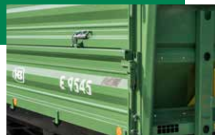
Fixations pour un montage et un démontage rapide
