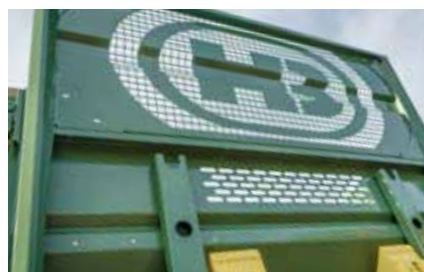
La grande grille de protection protège des projections de pierres et offre une visibilité optimale dans l'espace de chargement
