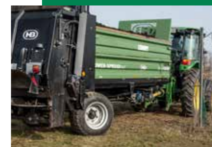
Innovation de Brantner essieu directionnel hydraulique en option
