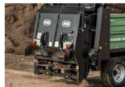
Épandeur universel CL2-2 pour compost, équipé de deux hérissons horizontaux et disques d'épandage
