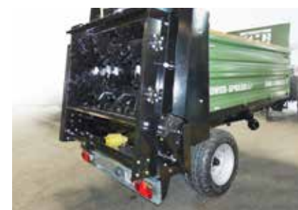
Mécanisme d'épandage F2H Mécanisme d'épandage fin avec deux hérissons horizontaux.
