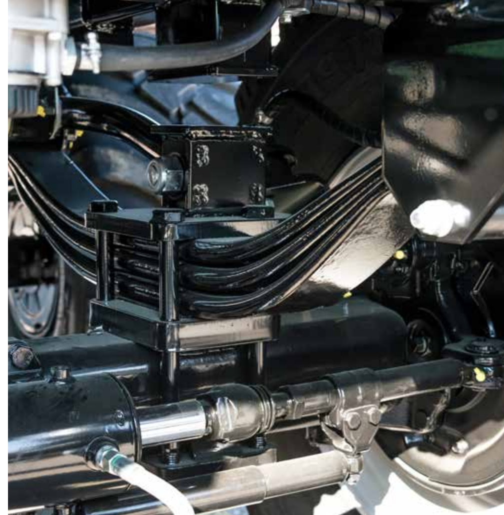
32 to Federaggregat mit verstärkter Ausgleichswippe
