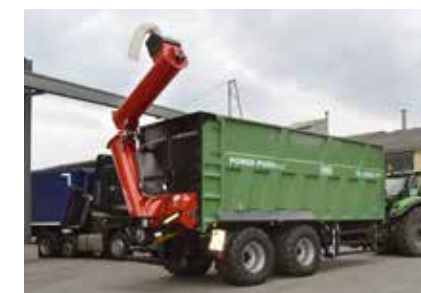
Überladeschnecke hydraulisch klappbar, mit Querförderschnecke
