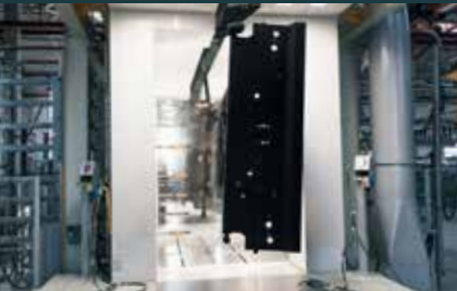
Pulver automatische Pulverbeschichtung
