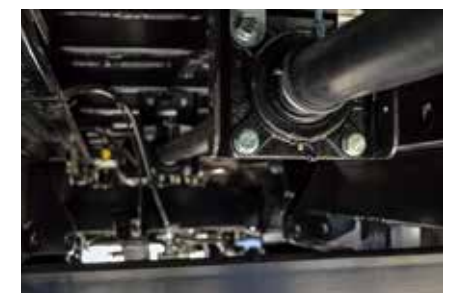
Zapfwelldurchtrieb für den Anbau von Streuwerk oder Überladeschnecke
