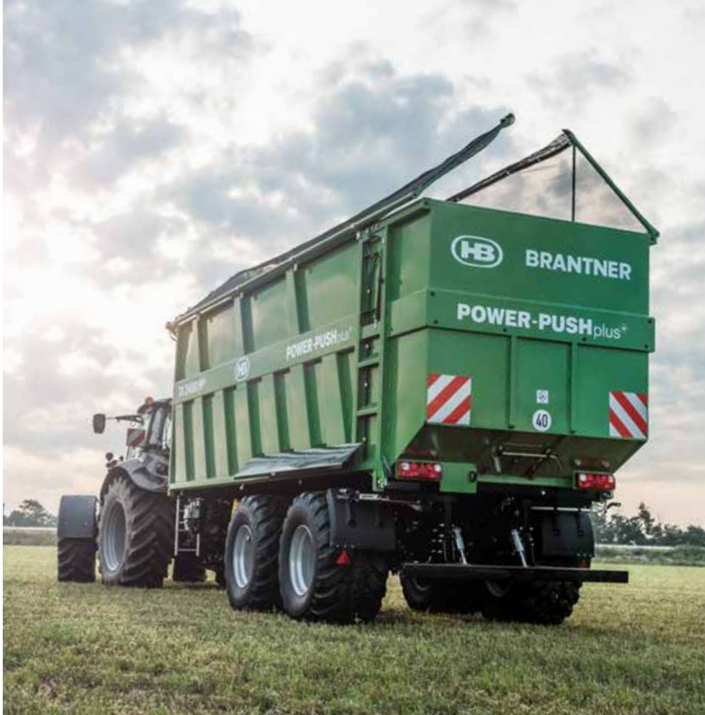
Parois intérieures absolument lisses, sans vis, préservant les joints.
