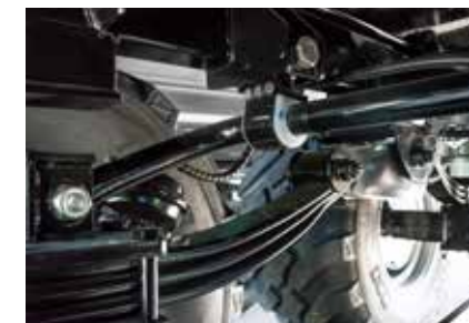
Stabilisateur de ressort, fortement recommandé pour les essieux directionnels (uniquement possible avec suspension à ressorts paraboliques).
