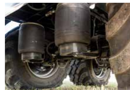
Suspension avec différents systèmes possibles, par exemple suspension à air ou suspension hydraulique.
