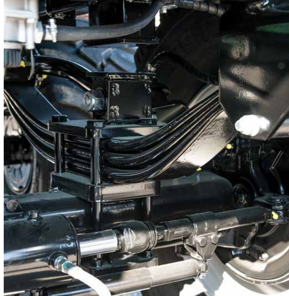
Groupe de suspension de 32 tonnes avec bascule d'équilibrage renforcée.
