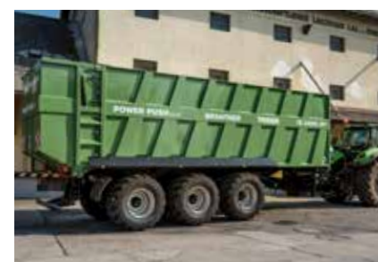
TR 34090 PP+ est équipé d'un châssis Tridem, avec un poids total de 34 tonnes et un volume de chargement de 43 ou 49 m 3
