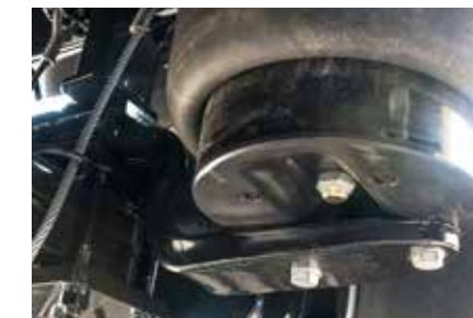
Suspension pneumatique avec bras à deux lames pour une stabilité et une aptitude au tout-terrain optimales.
