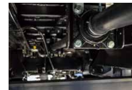
Prise de force Prise de force traversante pour le montage d'un mécanisme d'épandage ou d'une vis de transbordement.
