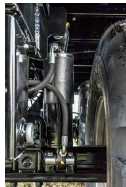
Suspension hydraulique pour une stabilité maximale dans les virages et les pentes.
