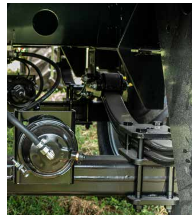
Parabelfederung für optimale Lastverteilung
