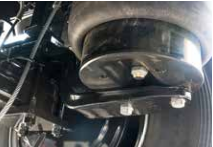
Ressort de direction renforcé pour une stabilité et une aptitude tout-terrain optimales
