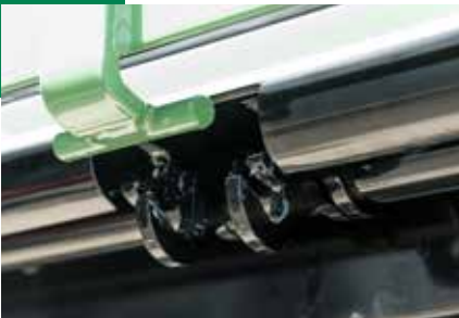
Charnières de parois latérales à partir d'une longueur de plateau de 5 mètres, avec double verrouillage
