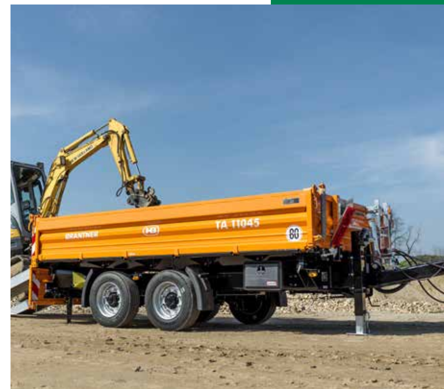
TA 11045 surbaissée la remorque surbaissée est équipée d'un système d'insertion permettant d'intégrer des rampes de chargement et des béquilles de stabilisation, disponibles en option.
