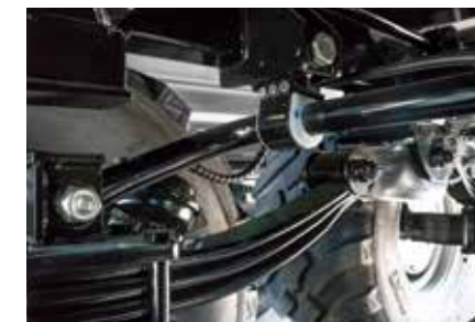
Stabilisateur de ressort disponible en option, recommandé pour les essieux directeurs
