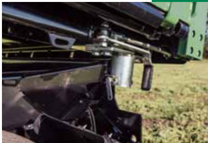
Paliers de basculement très à l'extérieur pour encore plus de stabilité
