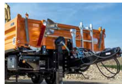
TA 13045 surbaissée de série avec timon d'attelage réglable en hauteur, support pour pelle et balai disponible en option
