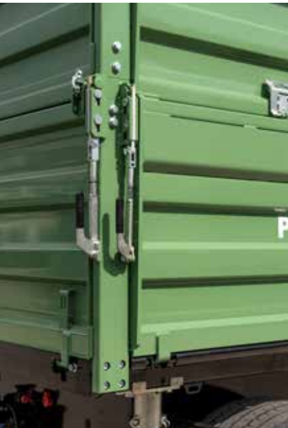
Fermetures HB de type camions commande confortable à une hauteur de travail optimale
