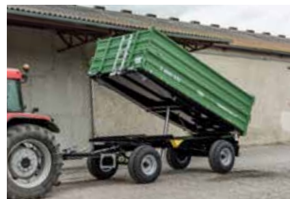
Z 8045 XXL avec frein à inertie et rehausses 500 mm
