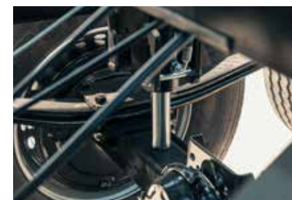
Soutien hydraulique de l'essieu arrière de série pour un confort de suspension optimal
