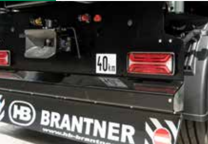
Éclairage de série avec feu arrière Agriled entièrement LED, avec résistance pour les clignotants
