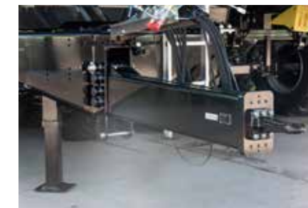
Timon réglable en hauteur fabriqué à partir de profilés pressés en double C, en tant qu'attelage en haut et en bas
