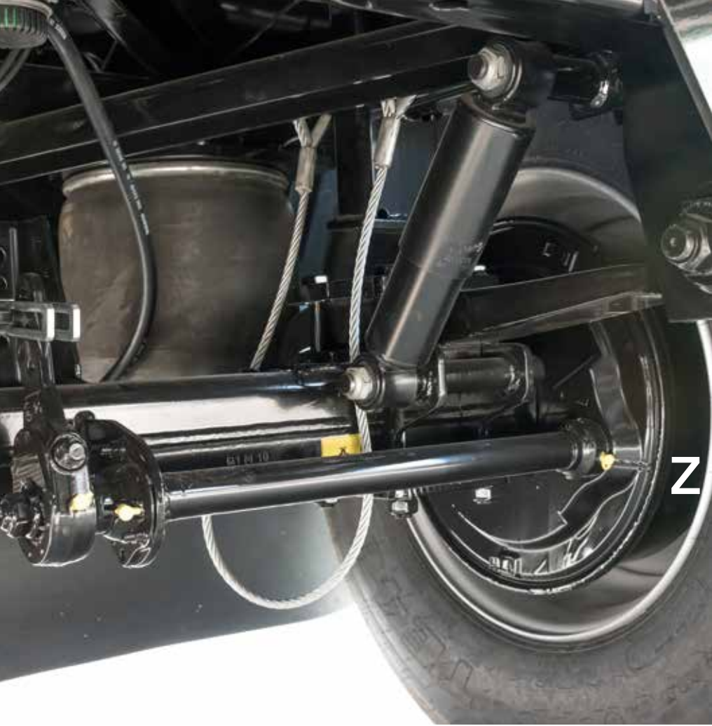
Suspension pneumatique standard type poids lourd avec amortisseur
