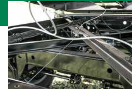
Renfort en croix rigidité de torsion renforcée
