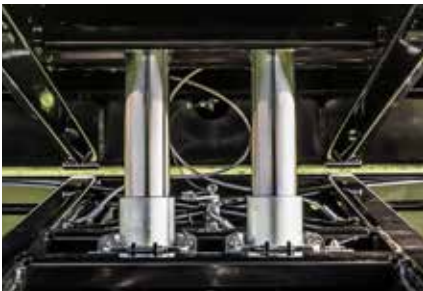
Vérin de basculement chromé dur monté sur cardan selon version une ou deux pièces
