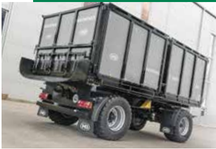
Rampe pour un déchargement optimal des produits en vrac sensibles (par exemple, les pommes de terre)
