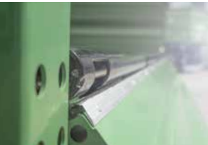
Bord du pont autonettoyant plié vers les quatre côtés
