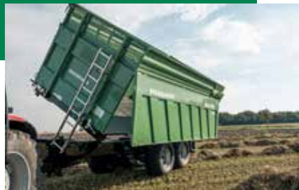
Paroi pendulaire parois STABILATOR montées sur pivot à gauche et à droite, faciles à ouvrir
