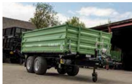
TA 8045 XXL avec frein à inertie et rehausses de 500 mm
