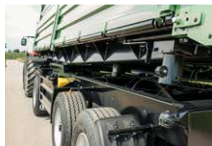
Cadre de basculement en forme de trapèze selon la conception des camions Avec des supports de basculement largement positionnés à l'extérieur.
