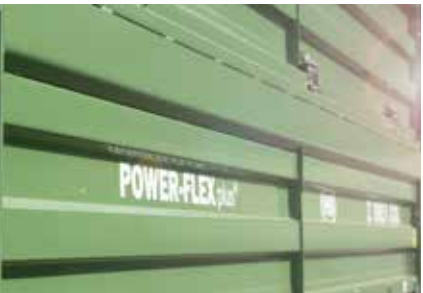
Renforts de parois latérales en tôle d'acier de 6 mm, soudés de manière fixe au profil du caisson
