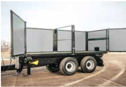
Porte à portique porte à portique de série à gauche (optionnellement à droite également possible), montée sur pivot
