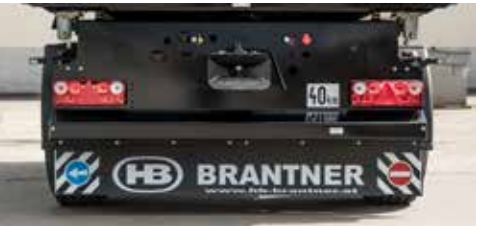
Éclairage Europoint II avec caoutchouc de protection contre les éclaboussures sur toute la largeur.
