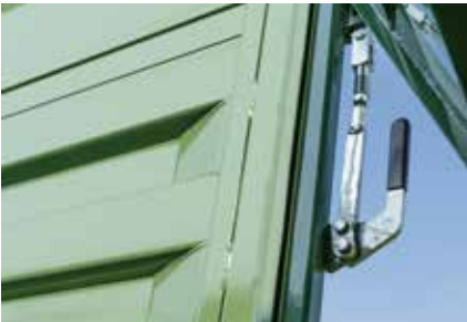
Joint labyrinthe métallique sur le montant d'angle pour les parois arrière et les rehausses
