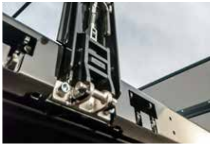
Poteau central amovible sans outil sur demande, utile lors du chargement de caisses ou de palettes
