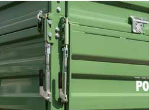
Fermetures HB - type camion, avec renfort de parois latérales.
