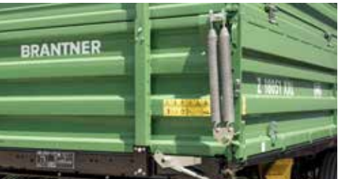
Double ressort de levage de ridelle, monté sur pivot
