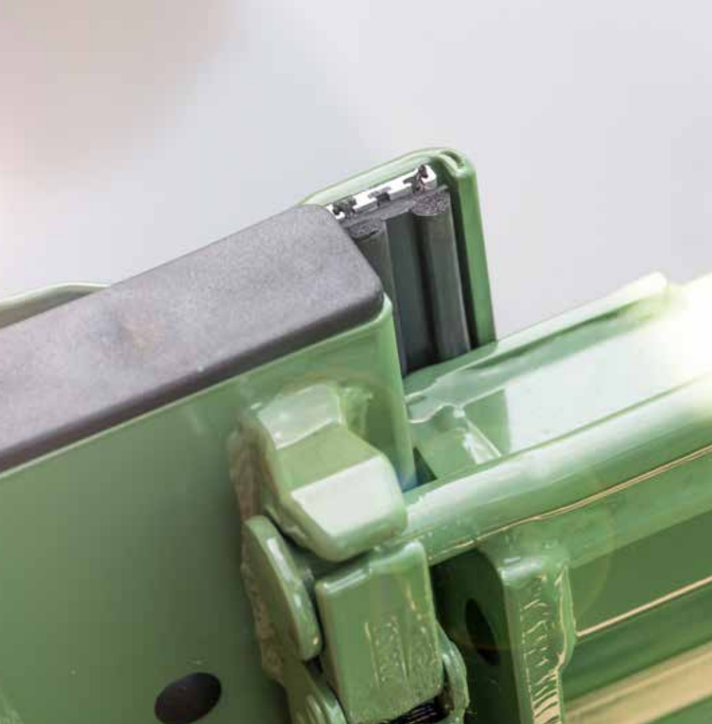
Système d'étanchéité PROFI version étanche aux grains avec joints en caoutchouc de haute qualité, interchangeables et insérables
