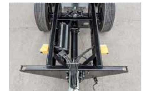
Cadre rectangulaire en profilés pressés G ou double C
