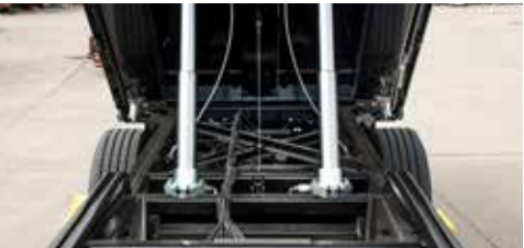
Version avec deux vérins de basculement
