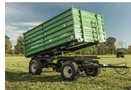
Z 18051 ACTION le modèle d'entrée de gamme en qualité Brantner éprouvée, avec cadre profilé double C pressé de série
