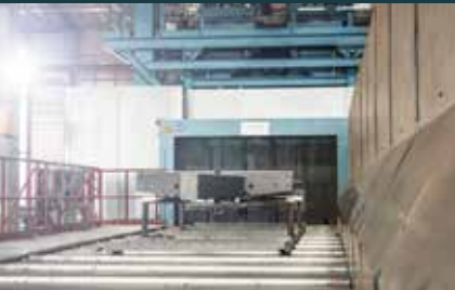
Sablage Prétraitement mécanique pour des surfaces propres et homogènes
