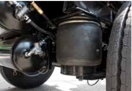
Réglage automatique du niveau pour une conduite agréable
