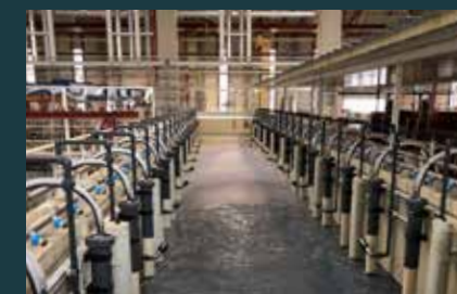
Vorbehandlung & KTL 12 Tauchvorgänge zur chemischen Reinigung und anschließende KTL-Beschichtung
