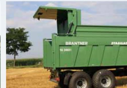
**Ouverture de paroi arrière hydraulique**
