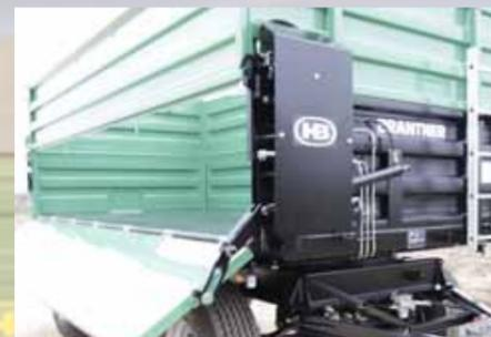
**ouverture dans le mur de panneau hydraulique** latéralement 180°,
