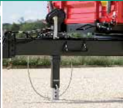
Potporna dizalica S 2 brzine
