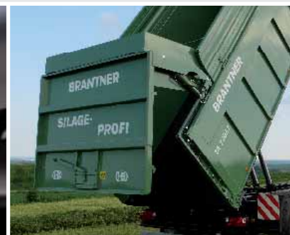
Hidraulično otvaranje stražnje stranice s dvostrukim djelovanjem
