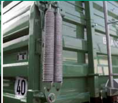
Opruge za podizanje bočne stranice Sprijeda s lijeve i desne strane po 2 komada (2 komada kao na slici moguća su samo za SB 800 mm)
