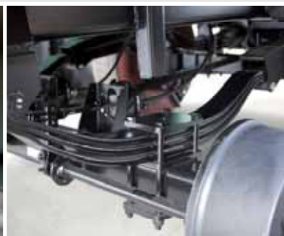
Parabolični ovjes s potporama
