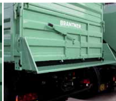
Klizište za krumpir, o d o s t r a g a Po cijeloj širini
