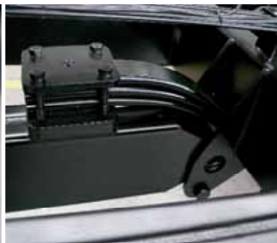
Rudo s oprugom S paraboličnom oprugom
