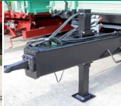
Hidraulična potporna noga S dvostrukim djelovanjem, na način "cijev u cijevi"
