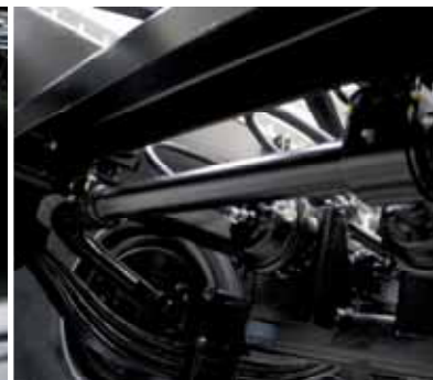
Stabilizator opruga Za optimalne vozne karakteristike, preporučuje se za skretnu osovinu
