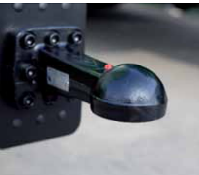
Priključak za kuglu K80 Za opterećenje preko 2,5 t
