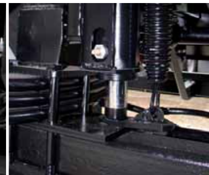
Hidraulična potpora za stražnju osovinu Za sigurno kipanje
