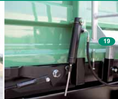
Hidraulički uređaj za otvaranje viseće stranice Može se utaknuti lijevo ili desno
