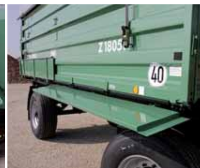
Bočno klizište za repu Stabilno bočno klizište (cca. 360 mm široko), otvara se zajedno s bočnom visećom stranicom
