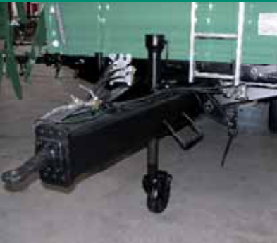
Potporni kotač S kutnim prijenosom
