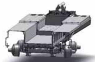
Detaljni pogled na okvir korita
