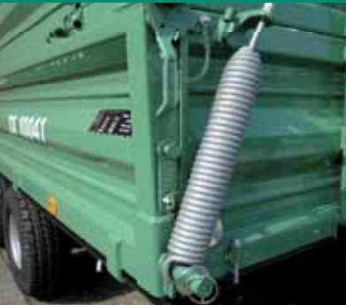
Opruga za podizanje bočne stranice Po jedna s lijeve i desne strane
