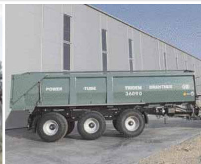
TR 36080/2 Power-Tube Prisilno upravljanje, samoopskrba uljem
