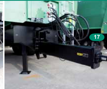
Donje priključivanje pomoću vučne cijevi Napravljeno od dvostrukog prešanog C profila, uključujući hidrauličnu potporna nogu
