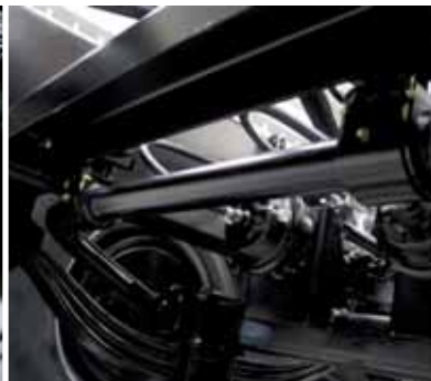
Federnstabilisator für optimale Laufeigenschaften, bei Lenkachse empfohlen
