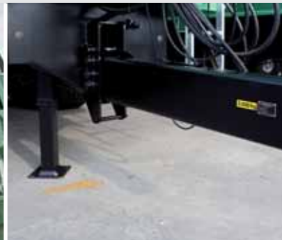
Untenanhängung mit Zugrohr aus Doppel-C Pressprofil, inkl. hydraulischem Stützfuß
