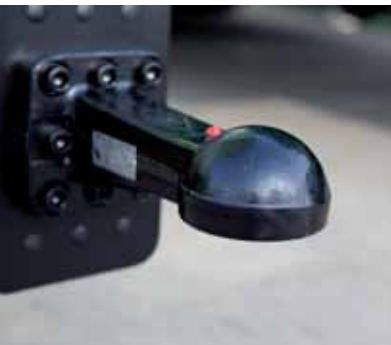
Kugelumkupplung K80 für Stützlasten über 2,5 t
