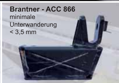
Grundierung + 2K Lackierung sichtbare Unterwanderung < 35 mm
