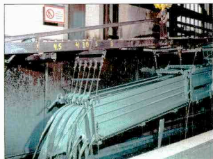
Fluten der Bordwände zur Hohlraum-lackierung.
