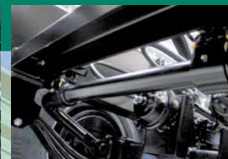
Rugó stabilizátor az optimális futásjellemzőkhöz
