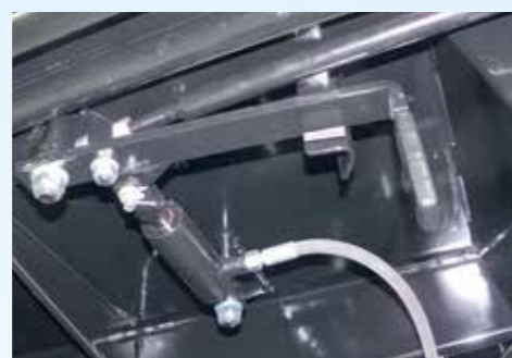
Hidraulikus lengő oldalfal reteszelés hátról
