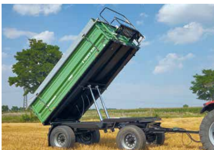
Z 13045/2 XXL 2 billentő munkahengerrel az optimális billentési stabilitás érdekében ponyvafelépítmény
