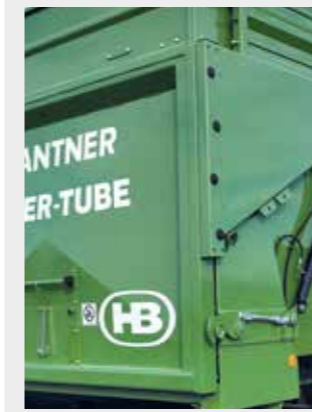
E 11045 Power-Tube egytengetes hátrabilenős pótkocsi (ráfutófékkal is és 8 tonnás HzGG lehetséges = E 8045 PT)
