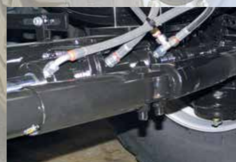
Utánfutó kormánytengely reteszelni kell hátrahúzásnál és közúti közlekedésnél
