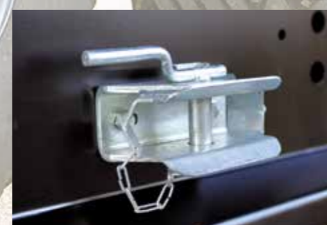
Pótkocsi vonóhorog 25 km/h felett 8 tonna összsúlynál
