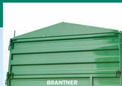
Háromszög magasító 300 mm magas elöl és hátról
