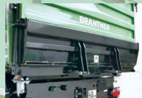
Hidraulikus hátsó fal nyitás 120° préselt profilból
