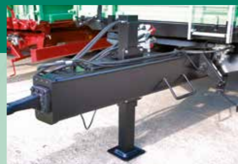
Hidraulikus támasztóláb kettősműködésű, cső-a-csőben vezetés
