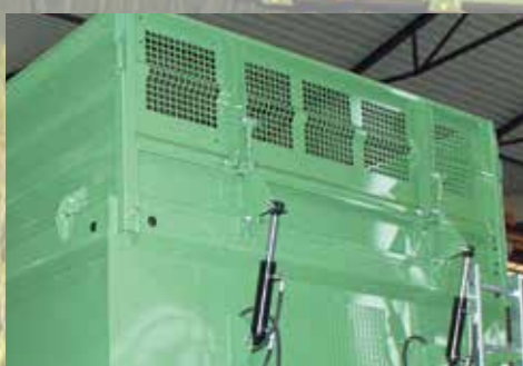
Homlokfal hidraulikusan lebillenthető
