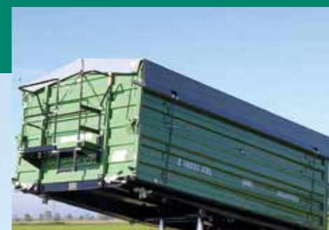
Ponyva felépítmény háromszög magasítókkal és kezelőplatformmal
