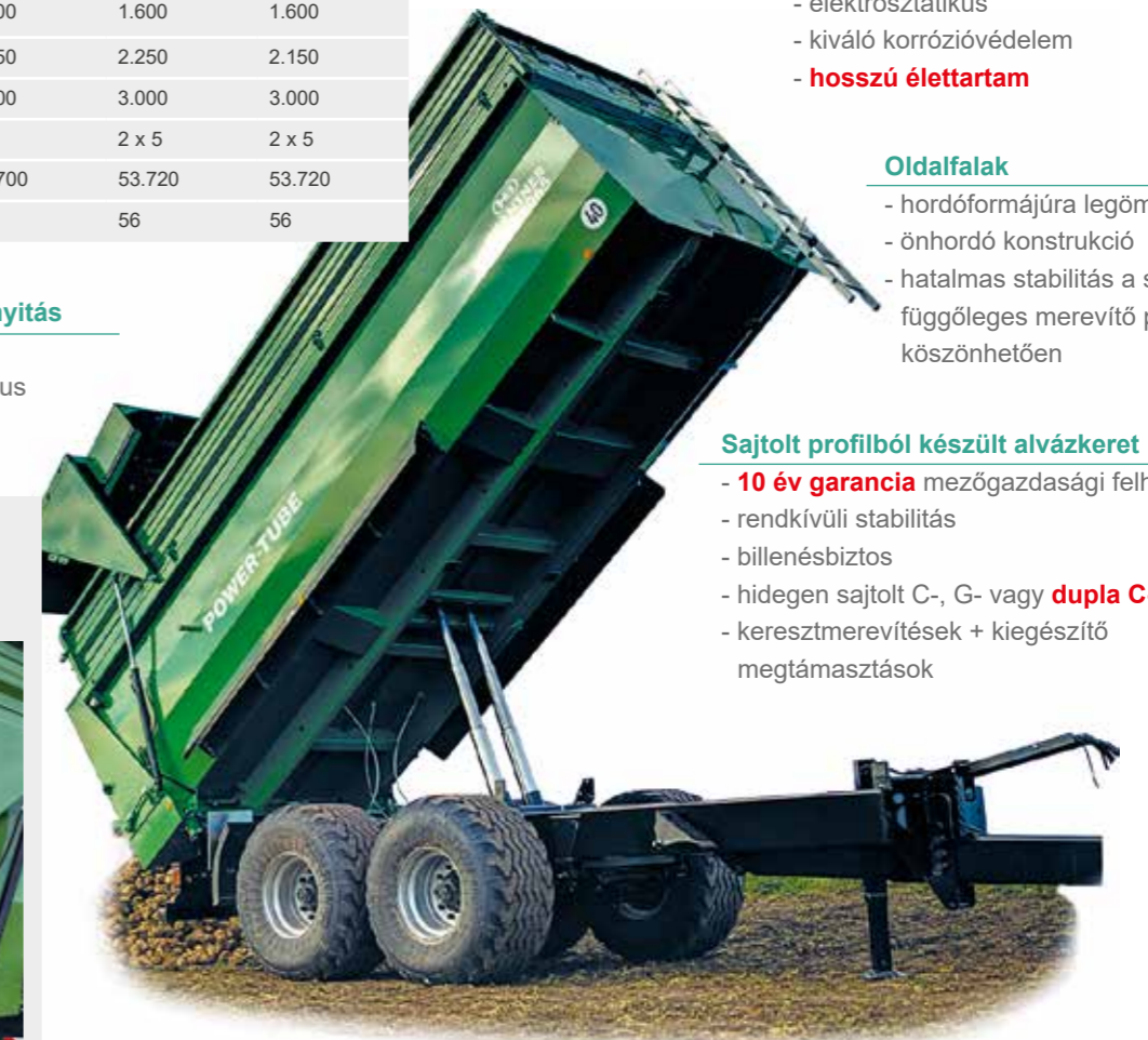
TA 11045 Power-Tube minden Power-Tube 50° billenési szöggel
