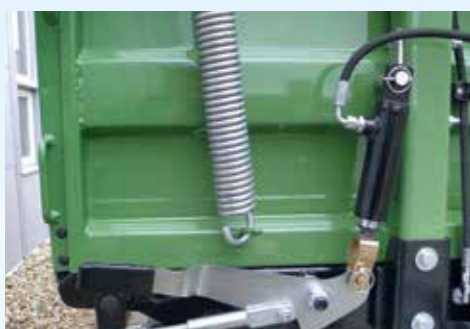
Hidraulikus lengő oldalfal reteszelés balra és jobbra átdugható
