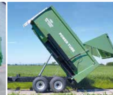
TA 11045 Power-Tube minden Power-Tube 50° billenési szöggel
