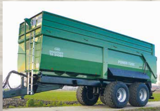
TA 24080/2 Power Tube teknő hossza 8.000 mm (kormányzott tengely a nyomtáv 2.250 mm alapkivitelben)
