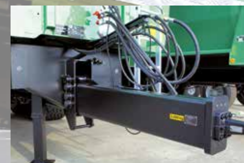
Alsó bekötéses vonórúd dupla-C- préselt profilból készült vonócsővel
