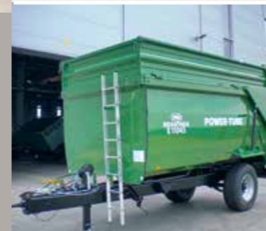
E 11045 Power-Tube egytengetes hátrabilenős pótkocsi (ráfutófékkal is és 8 tonnás HzGG lehetséges = E 8045 PT)
