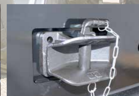
Pótkocsi vonóhorog 25 km/h felett 15 tonna összsúlynál
