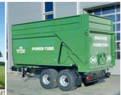
TA 14045/2 Power-Tube két billentő munkahengerrel az optimális billentő stabilitásért
