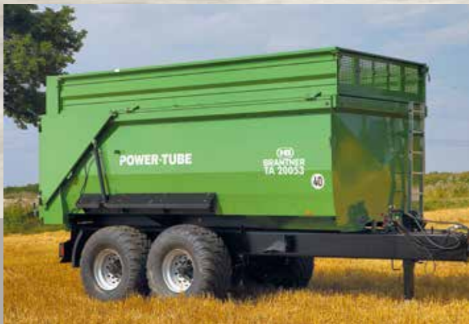
TA 20053 Power Tube teknő hossza 5.300 mm, 600 mm-es oldalfal magasítással
