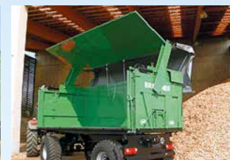
Hidraulikus Stabilator oldalfal felfelé nyíló
