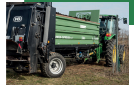
Innovation von Brantner optionale hydraulische Lenkachse
