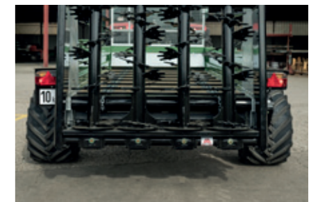
Spurweiten mit 2150/2200 mm bei allen Bergstreuer-Typen
