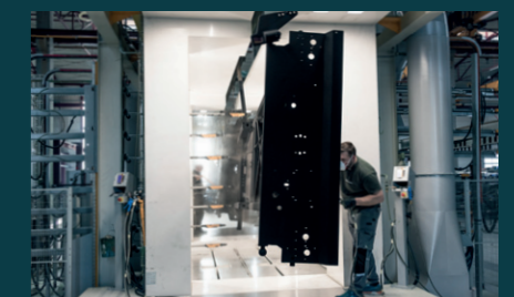
Pulver automatische Pulverbeschichtung
