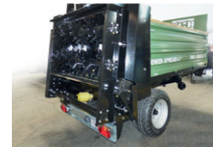
Streuwerk F2H Feinstreuerwerk mit zwei horizontalen Fräswalzen
