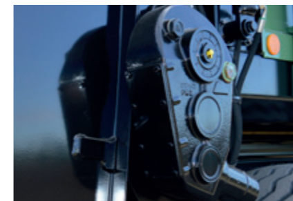
Stufenloser Kratzbodenantrieb ein robustes, im Ölbad gelagertes Getriebe bei allen Brantner Streuern
