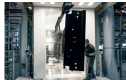
Einzigartig KTL- & Pulverbeschichtung idealer Schutz vor Korrosion
