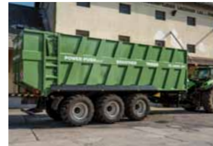
TR 34090 PP+ Tridem Fahrwerk, 34 to GesGew., 43 oder 49 m 3 Ladevolumen
