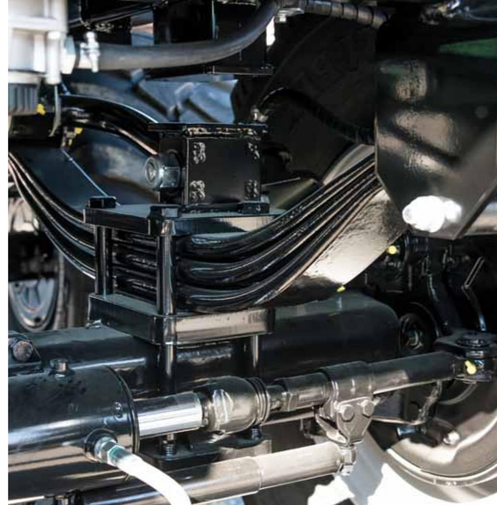
32 to Federaggregat mit verstärkter Ausgleichswippe
