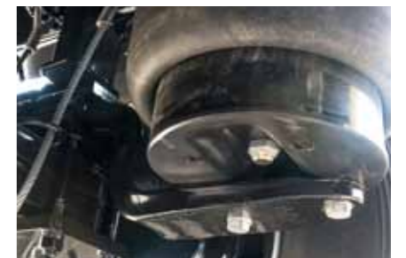
Luftfederung mit Zweiblattenlenker für optimale Standsicherheit und Geländegängigkeit
