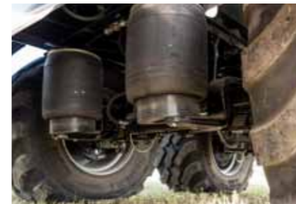
Federung verschiedene Systeme möglich, z.B. Luftfederung oder Hydraulikfederung
