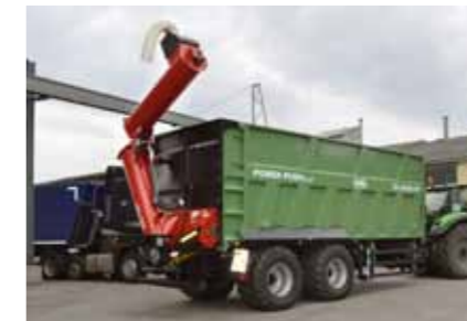
Überladeschnecke hydraulisch klappbar, mit Querförderschnecke
